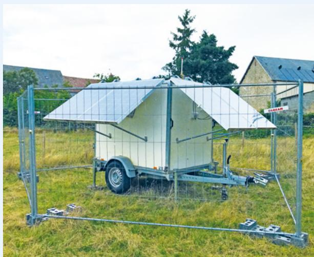
Pour effectuer les mesures de vent à Nouhant, nous avons décidé d'utiliser un Lidar, une technologie moderne et facile à déployer en comparaison aux mâts de mesure utilisés habituellement.
