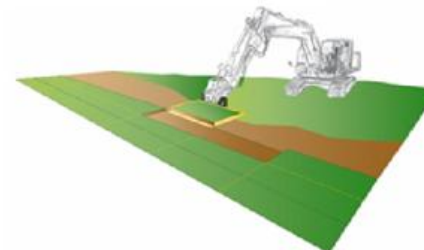
Étape 3 : déchargement des dalles sur la zone réceptrice et positionnement/nivellement dans les zones réceptrices
